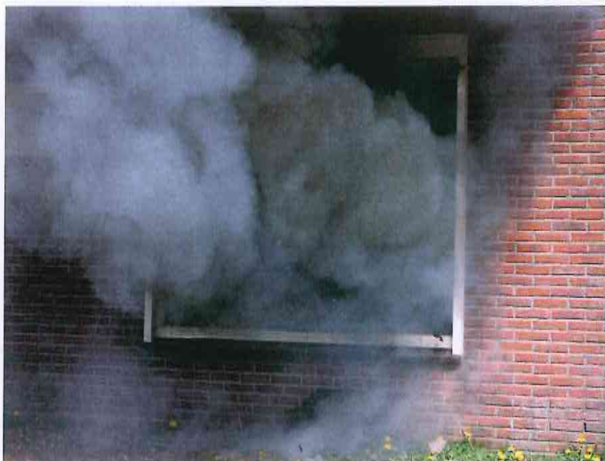
A-2.1: lichtgrijze rook: een relatief schone en volledige verbranding
