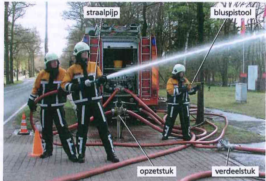
B-1.9: watervoerende armaturen
