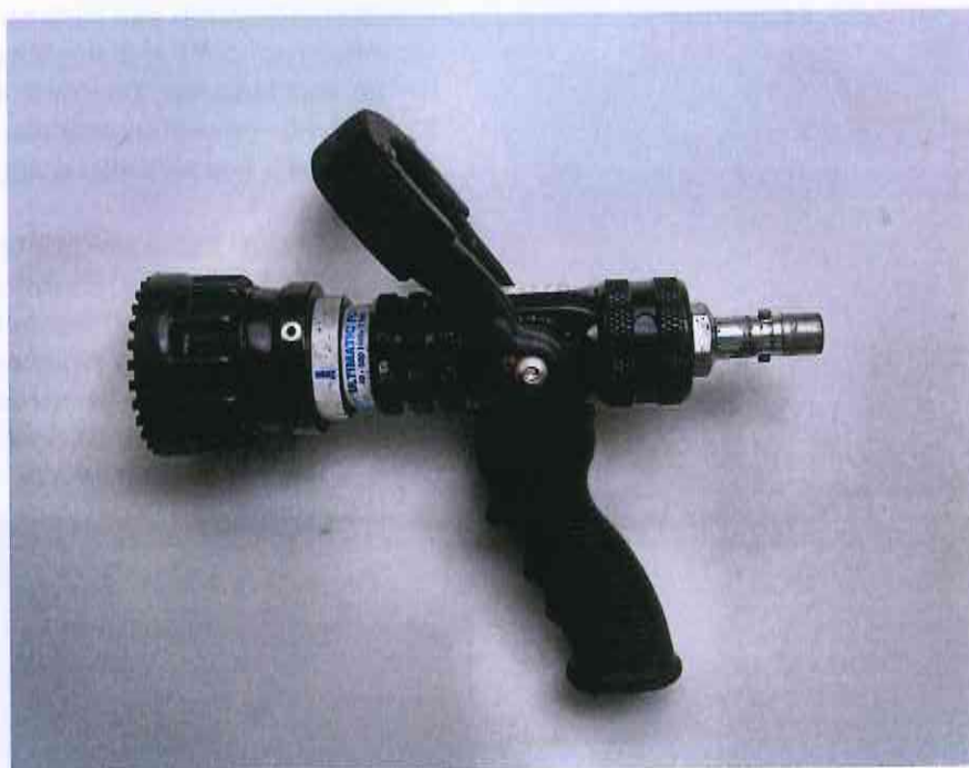
C-2.9: een voor brandgaskoeling geschikte straalpijp
